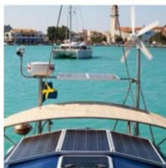
VÄNSTER: Mitt hemmabygda doghouse börjar ta form. MITTEN: 400 W solpaneler och vindgenerator håller batterierna fulladdade. HÖGER: Efter 10 månader på land var det äntligen dags för sjösättning.
